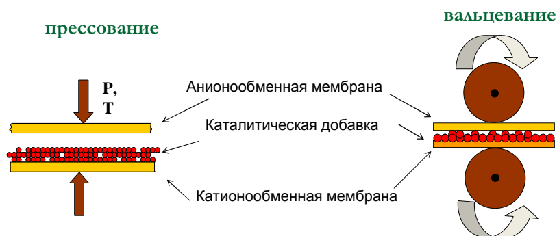
Рис. 2. Получение гетерогенной биполярной ионообменной мембраны, содержащей каталитическую добавку, из исходных катионообменной и анионообменной методом прессования и вальцевания
