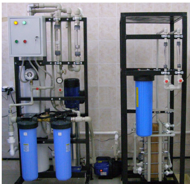
Рис. 25. Гибридная бароэлектромембранная установка с применением биполярного электродиализа производительностью 0,8 м 3 /ч, предназначенная для получения воды, применяемой для подпитки пароводяного контура паровых котлов
