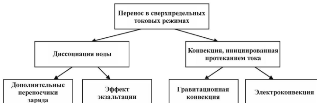
Рис. 7.10. Схема механизмов переноса в сверхпредельных токовых режимах [119]
